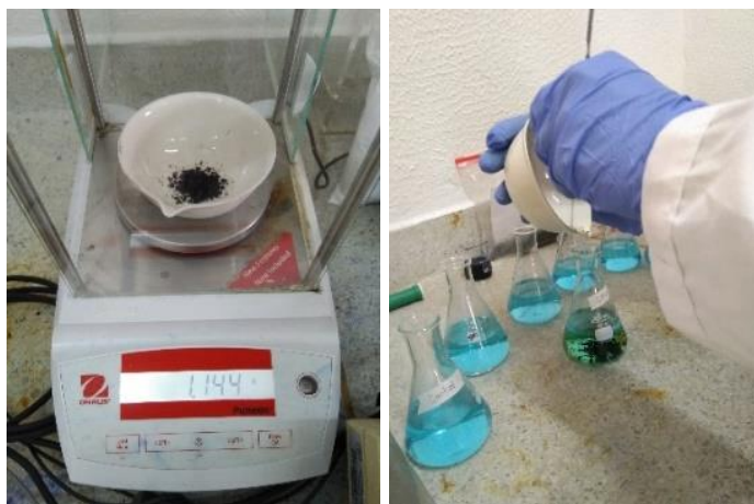
Ilustración 48. Distribución de biomasa residual en matraces de Erlenmeyer.
