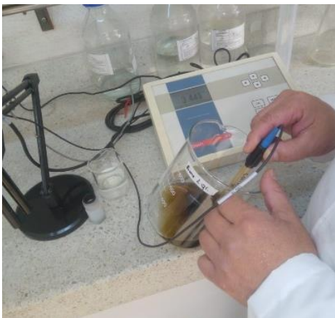
Ilustración 56 Medición de pH para agua preparada con MNPs@biomasa residual y biomasa residual.
