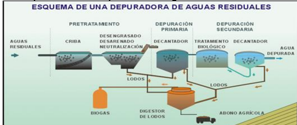
Figura 2. Esquema de una Depuración de Aguas Residuales
