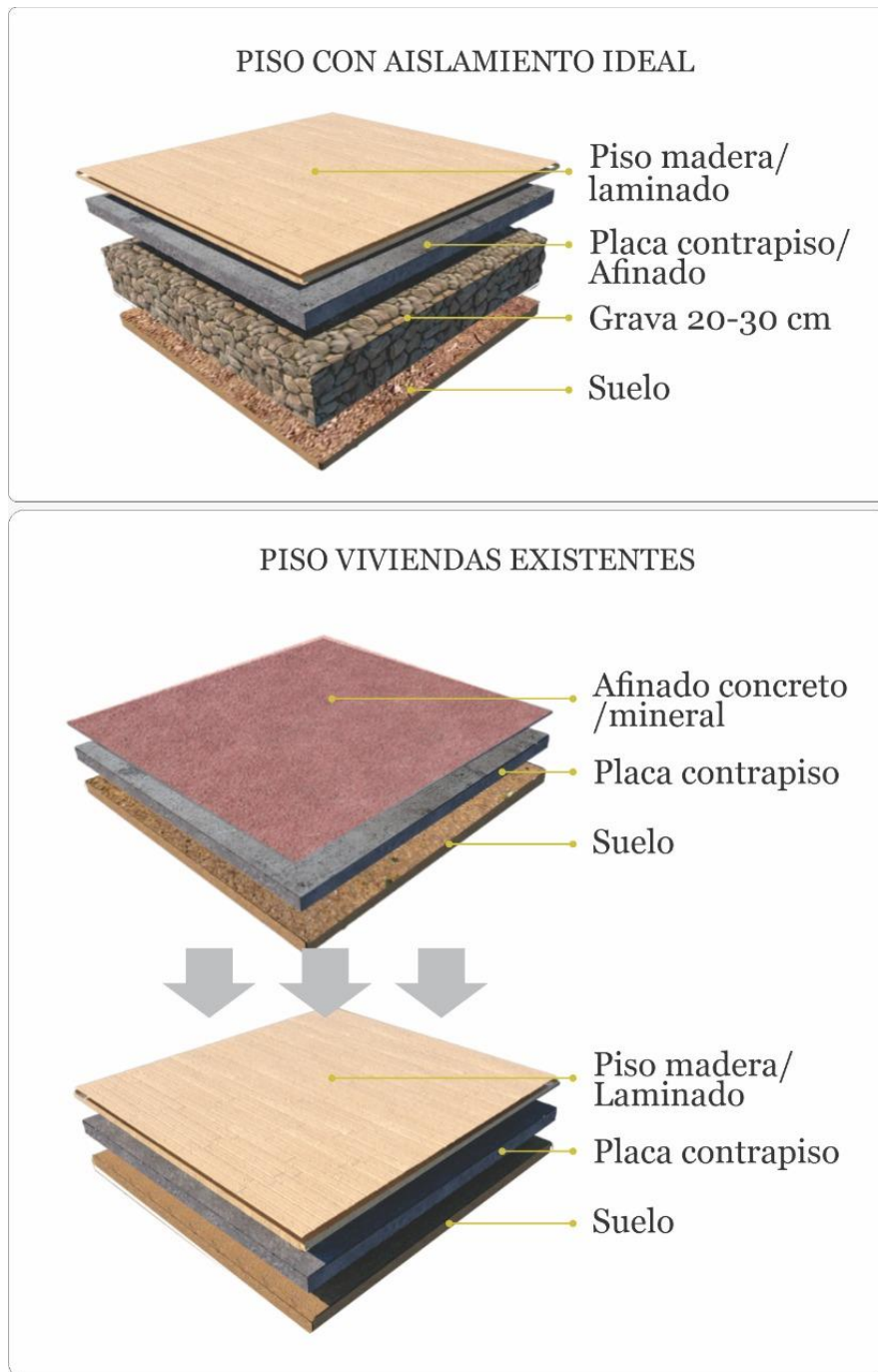
Figura 55. Aumento en aislamiento piso vivienda existente y propuesta. Fuente: Elaboración propia, 2020. CC BY-NC 4.0
