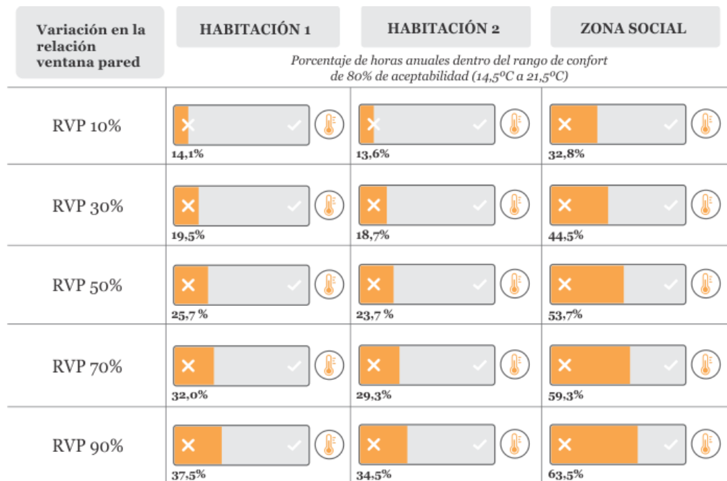
Figura 48. Porcentaje de horas dentro del rango de confort según relación ventana pared. Fuente: Elaboración propia, 2020. CC BY-NC 4.0
