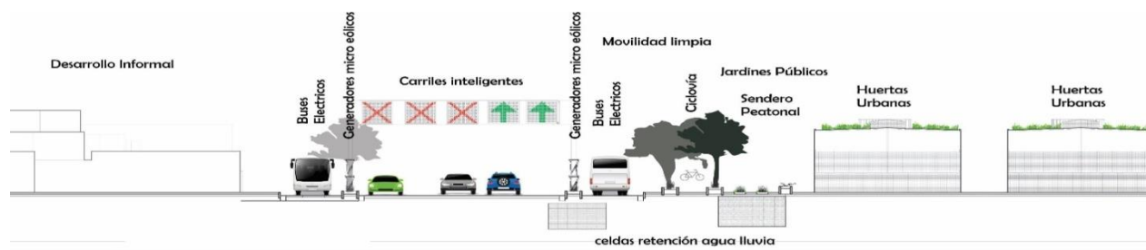
Figura 38. Propuesta por el autor de perfil vial sostenible Av. 1 de mayo. Fuente: Elaboración propia. CC-BY-NC-ND
