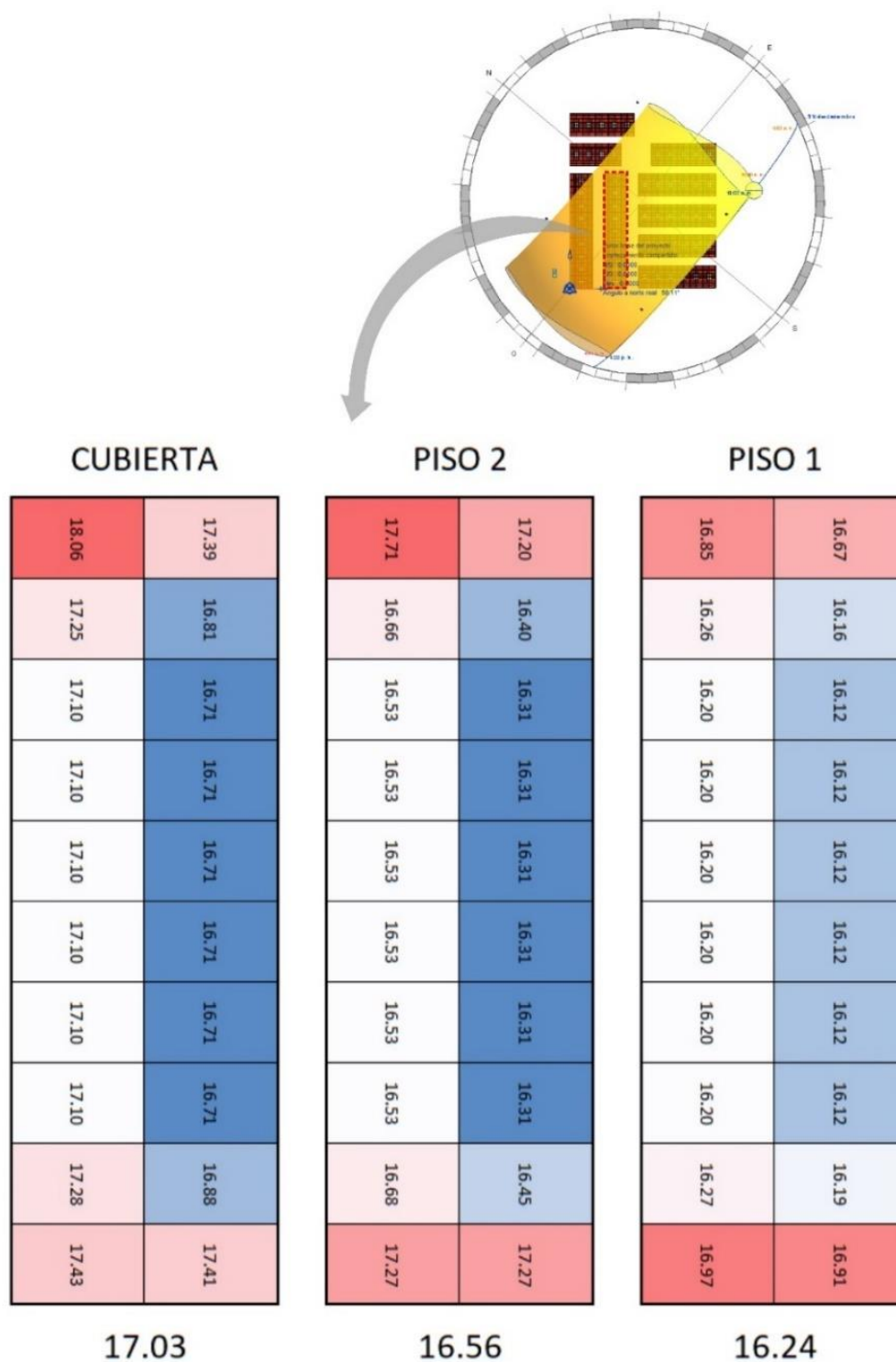
Figura 20 Bloque 2 Simulación por pisos temperaturas operativas anuales promedio. Fuente: elaboración propia con datos arrojados por el programa Design Builder CC-BY-NC-ND
