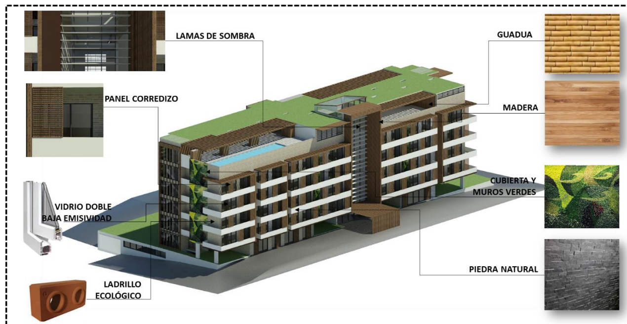
Figura 64. Modelo propuesto-diseño final. Elaboración propia. 2021. CC BY-NC-NA
