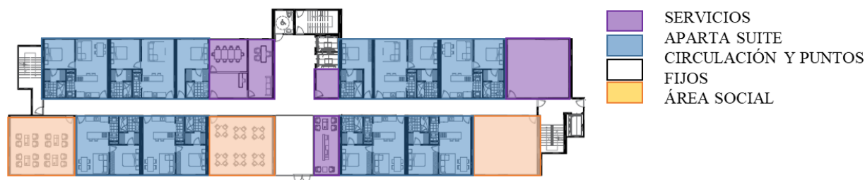
Figura 16. Zonificación primer piso proyecto hotelero. Elaboración propia en Design Builder. 2021. CC BY-NC-NA.
