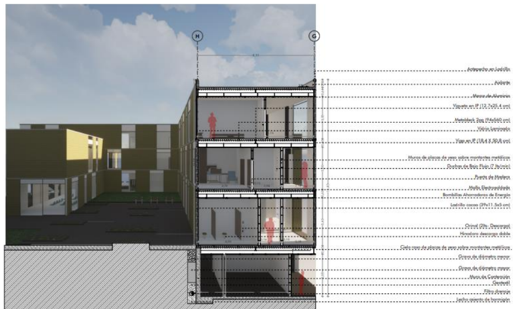
Figura 8. Corte fachada Fuente: Elaboración propia, 2021.
