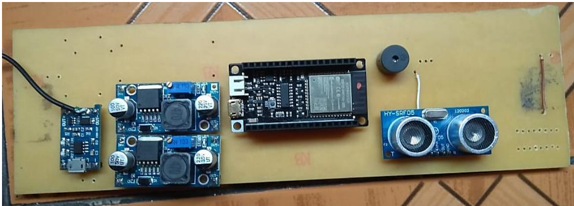
Figura 15 Ensamble de componentes electrónicos
