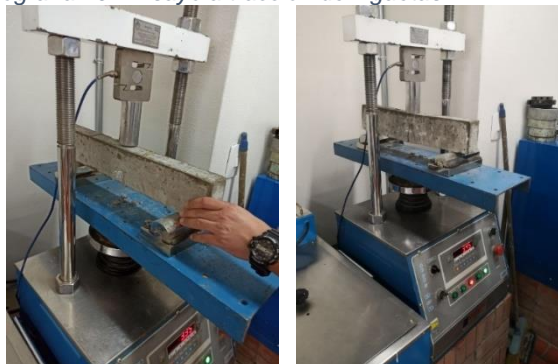
Fotografía 20. Ensayo a tracción de viguetas.
