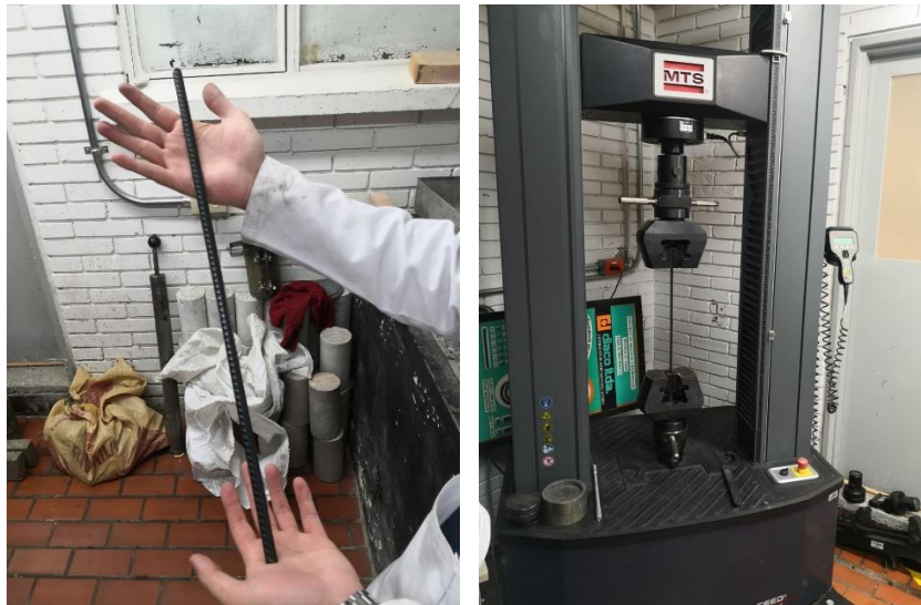
Fotografía 10. Ensayo a tracción del acero.
