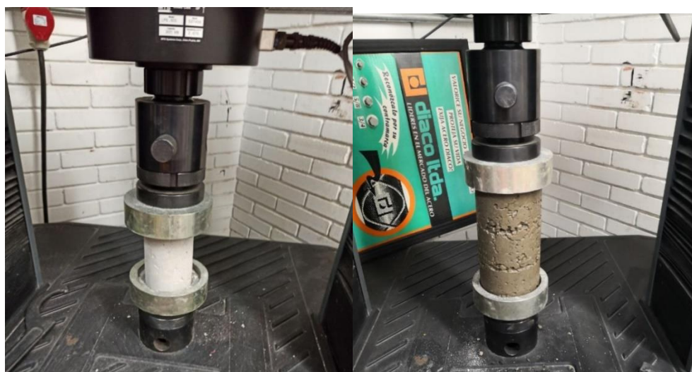
Fotografía 19. Ensayo a compresión de cilindros.
