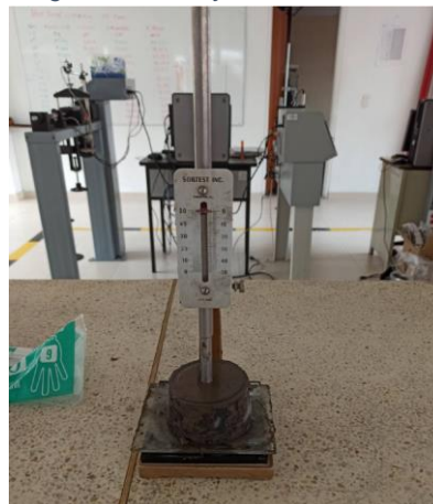
Fotografía 2. Ensayo consistencia del cemento.
