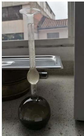
Fotografía 1. Ensayo de densidad del cemento.
