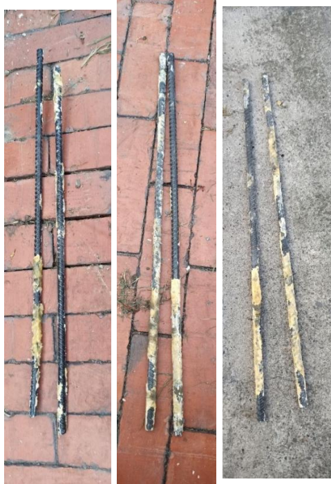
Fotografía 25. Varillas viguetas con recubrimiento
