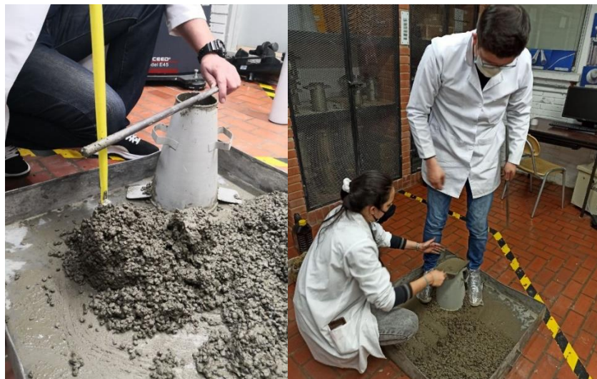
Fotografía 18. Ensayo cono de Abrams.
