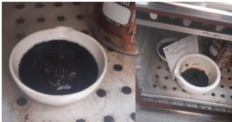
Ilustración 19. Secado de BiomasaResidual@MNPs .
