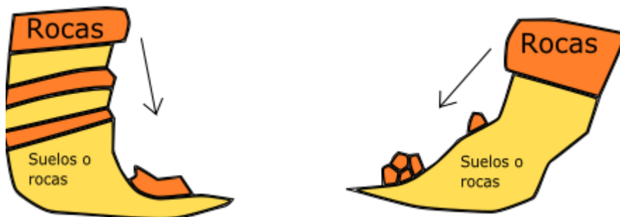
Ilustración 4 Desprendimiento de rocas.
