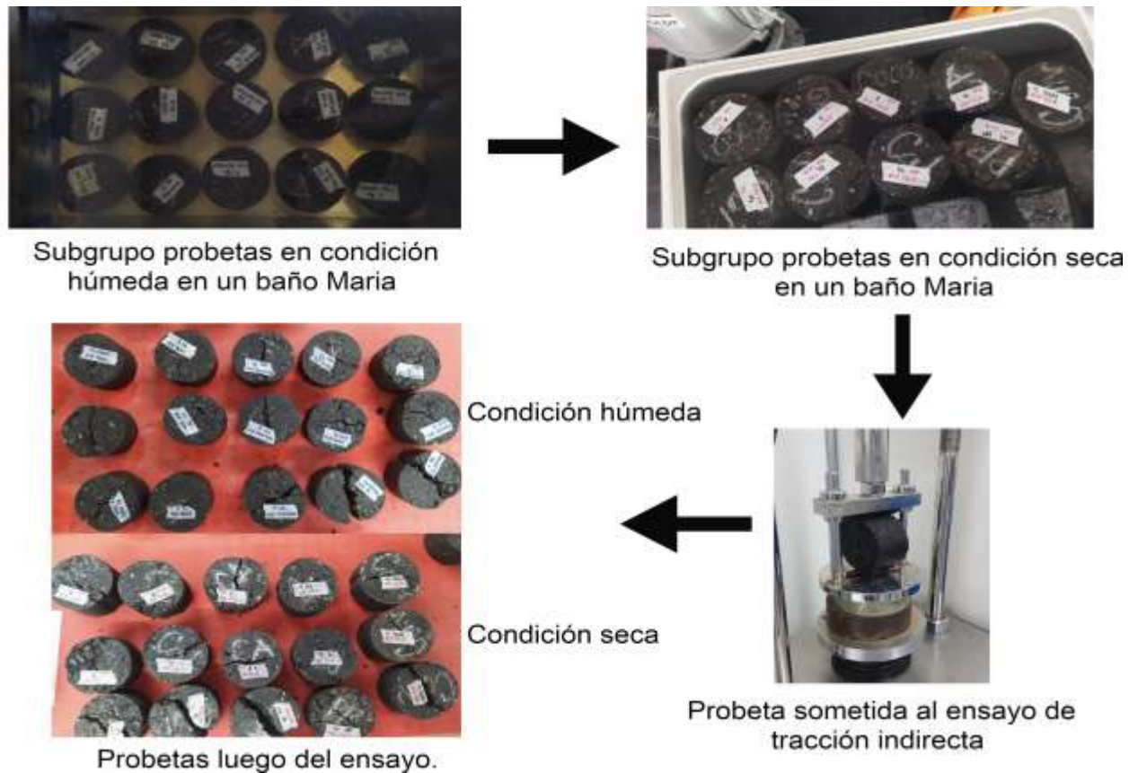
Figura 16. Ensayo de tracción indirecta.
