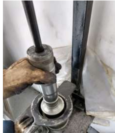
Figura 10. Compactación de briquetas
