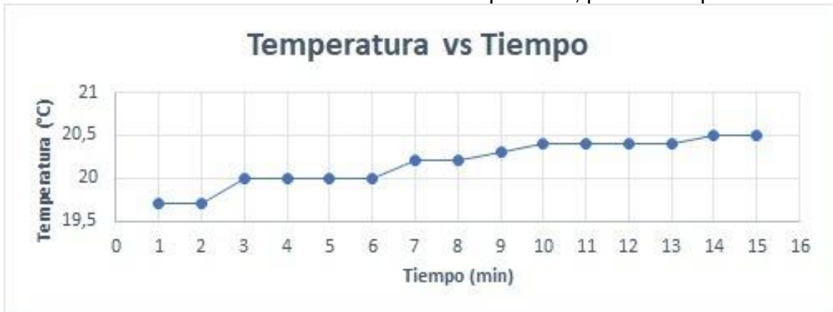
Ilustración 25 Gráfico de resultados de temperatura, prueba lámpara UV
