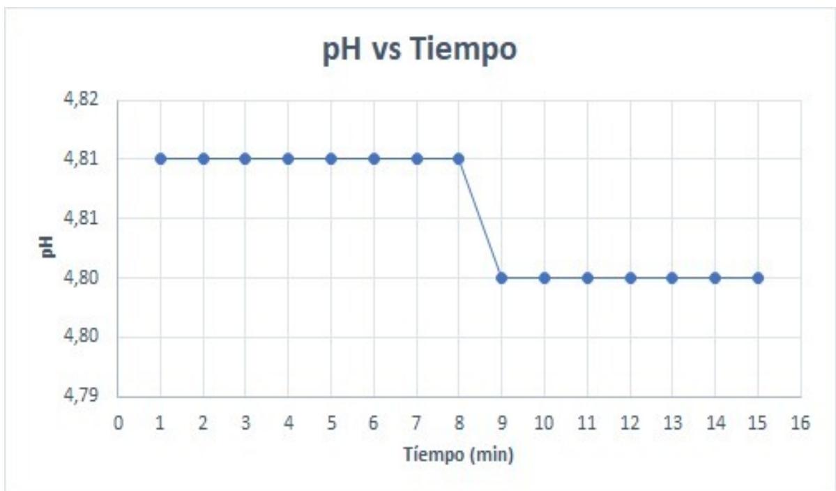
Ilustración 26 Gráfico de resultados de pH, prueba lámpara UV
