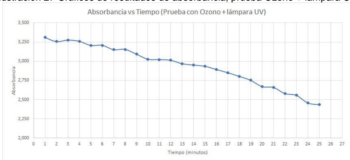
Ilustración 27 Gráficos de resultados de absorbancia, prueba Ozono + lampara UV
