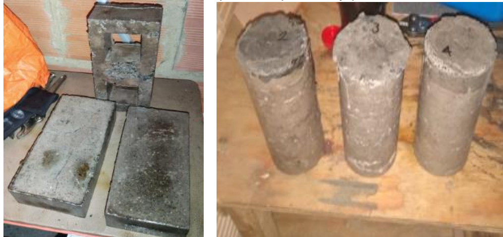
Ilustración 42 Elementos de mampostería plástica y probetas desencofrados.
