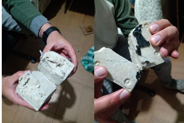
Ilustración 10 Evidencia de fractura del cubo de PET
