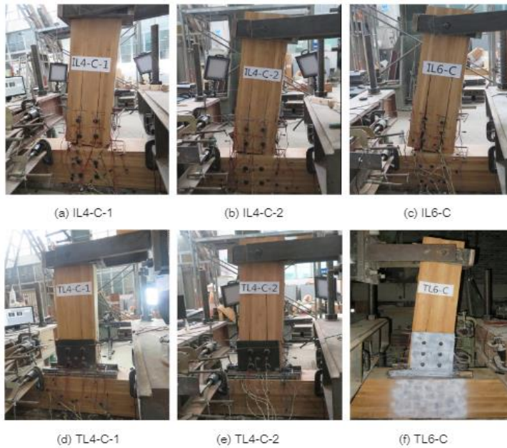
Figura 36. Métodos de falla.
