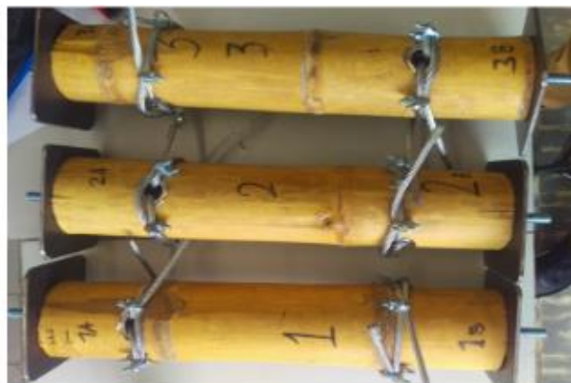
Figura 47. Probetas ensayo conexión sencilla
