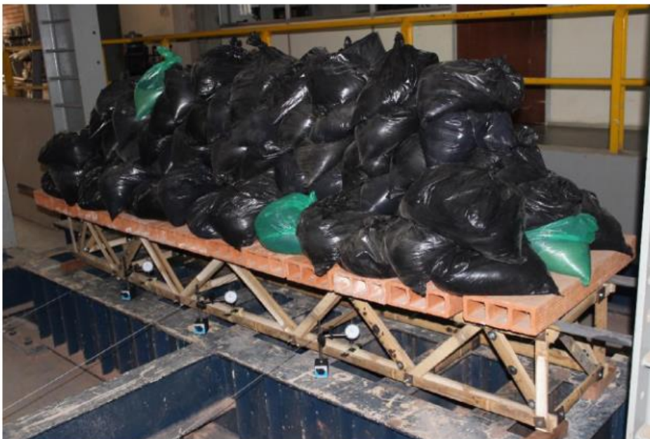
Figura 41. Segundo prototipo sometido a una carga distribuida de 12,017N
