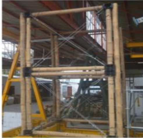
Figura 51. Módulo espacial de dos pisos.
