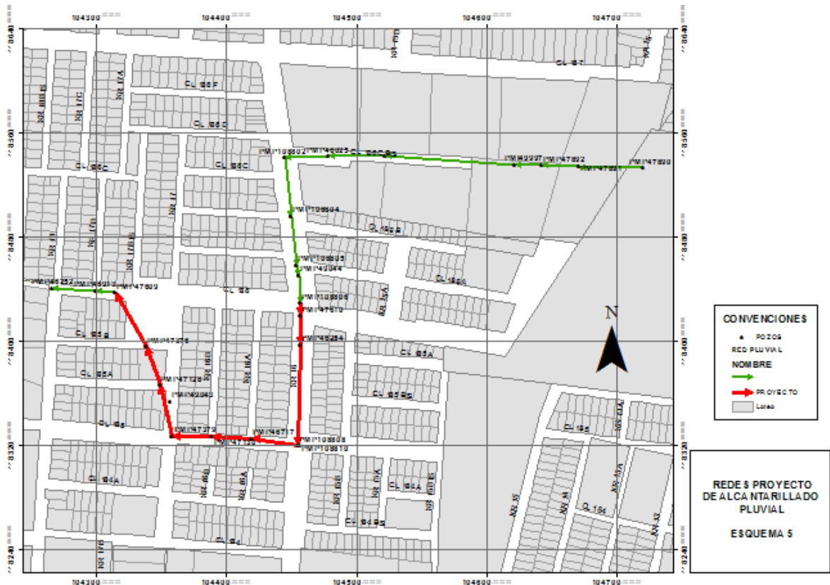
Figura 17 Redes de alcantarillado pluvial Fuente: Propia
