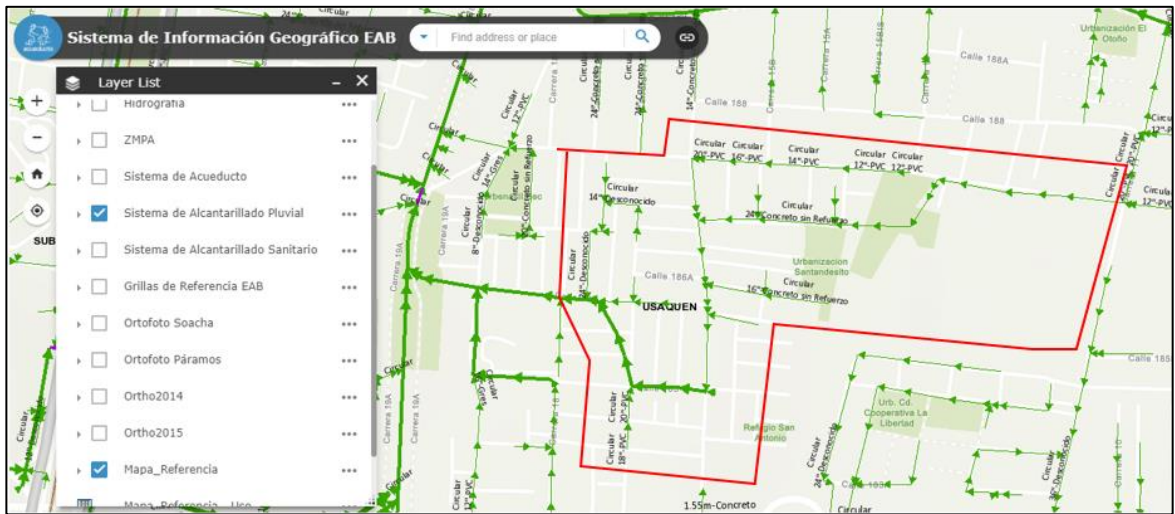
Figura 9 Red de alcantarillado pluvial existente en el sector Fuente: SIGUE EAB
