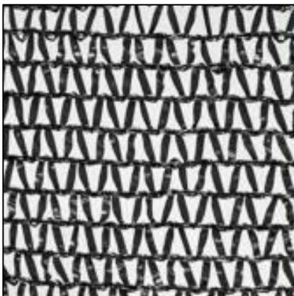
Figura 5. Malla Raschel al 35% de Sombreado para la Captación de Agua Niebla
