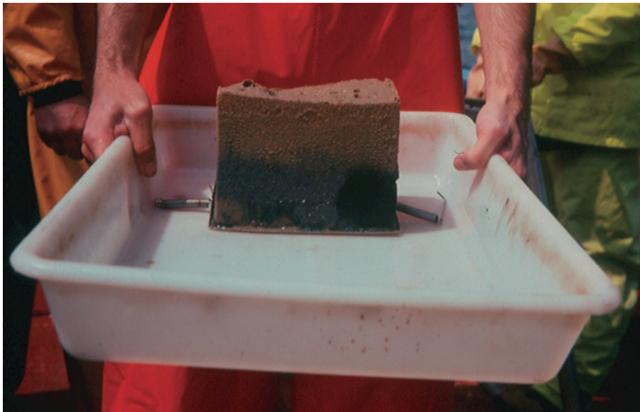
Figura 9: Aspecto de una muestra de sedimento extraída con el box corer en la estación BR2 (boca de la ría de Ares-Betanzos) en mayo de 1993. A unos 10-12 cm de la superficie se observa la arena impregnada de petróleo del vertido Aegean Sea (Parra 2007).
