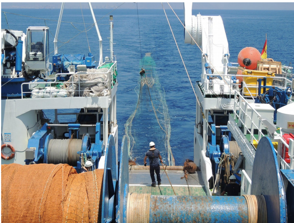
Figura 15: Arte de pesca empleado en la campañas MEDIAS. En la imagen puede apreciarse la gran apertura de este arte de pesca de arrastre pelágico JM Disdier 2020.
