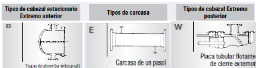
Figura 8.3.3. Diseño IC según las normas TEMA
