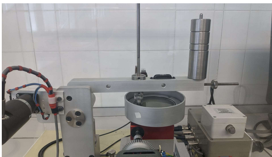
Figura 47. Ensayo de fricción en medios lubricados.
