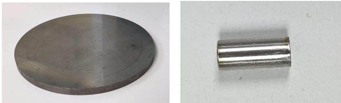
Figura 30. Par tribológico: Disco de acero AISI 304 (izquierda) y pin de acero AISI 304 (derecha)
