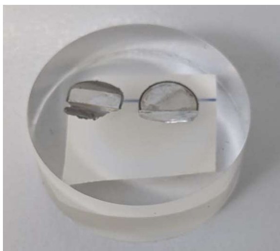
Figura 51. Muestra embutida en metacrilato
