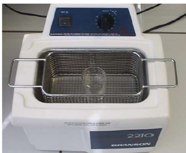
Figura 34. Equipo de limpieza por ultrasonidos Branson 2210
