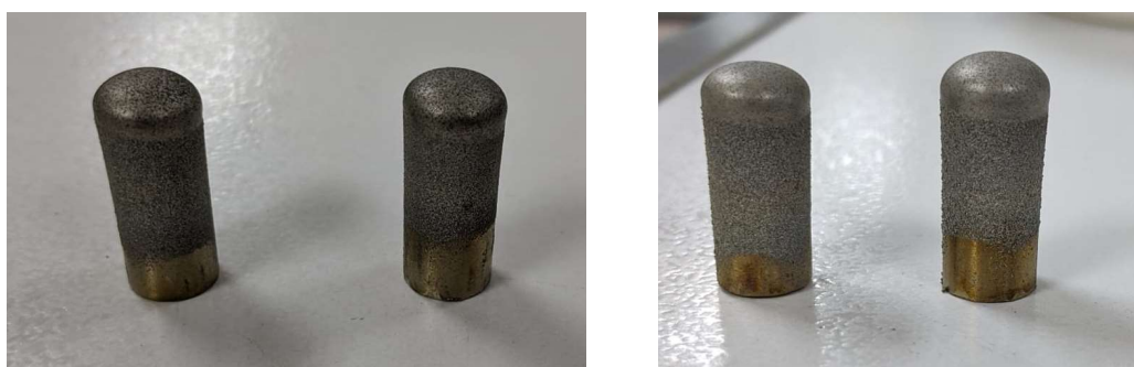
Figura 42. Izquierda: Pins con recubrimiento de NiCrBSi tras la refusión. Derecha: Pins con recubrimiento de NiCrBSi+alúmina tras la refusión
