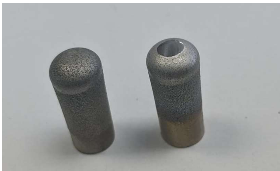
Figura 46. Muestra de NiCrBSi (izquierda) y muestra de NiCrBSi+alúmina pulida (derecha)
