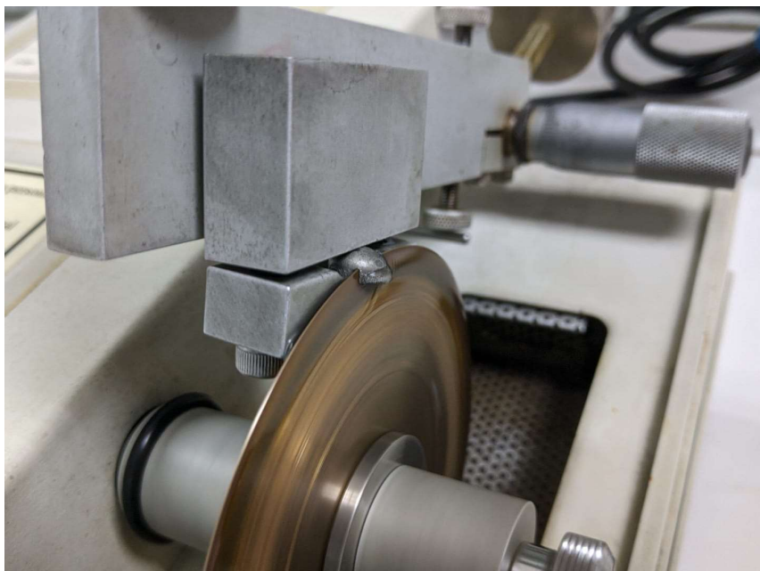
Figura 49. Operación de corte por disco Buehler ISOMET
