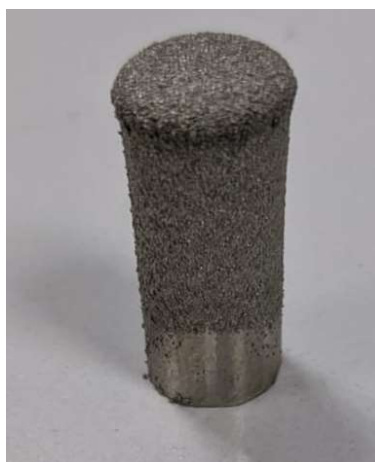
Figura 40. Pin con recubrimiento de NiCrBSi tras la proyección por oxy-fuel
