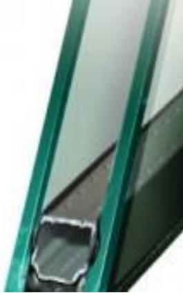
Los vidrios con cámara o de doble acristalamiento son vidrios formados por dos hojas separadas por una cámara intermedia de aire deshidratado sellada herméticamente que sirve para aumentar el aislamiento térmico. La cámara de aire reduce la transferencia de calor entre el exterior y el interior.
