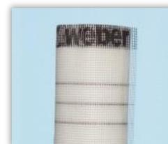
Malla constituida por hilos de fibra de vidrio con doble torsión y tratamiento de resina que las protege del ataque a los álcalis de los materiales cementosos. Confieren resistencia y estabilidad al revestimiento, evitando la aparición de fisuras debidas a las variaciones de temperatura y del movimiento de las placas de aislamiento. Además la malla contribuye a la mejora del comportamiento a la resistencia al impacto del revestimiento donde esté incorporada.
