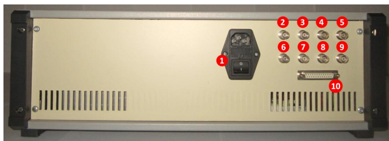
Figura 94 | Vista trasera del bastidor. (1) Conector de alimentación con interruptor y porta-fusibles integrado. (2) Salida del canal 4. (3) Salida del canal 3. (4) Salida del canal 2. (5) Salida del canal 1. (6) Salida del canal 8. (7) Salida del canal 7. (8) Salida del canal 6. (9) Salida del canal 5. (10) Conector de señales de sincronización.
