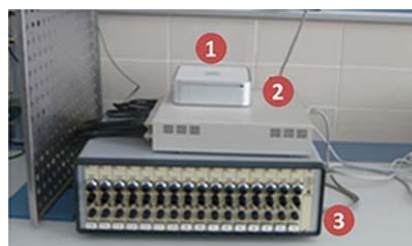
Figura 14 | Sistema de registro del laboratorio de Farmacología de la Universidad de La Laguna. (1) Ordenador. (2) Tarjeta de adquisición de señal. (3) Equipo de acondicionamiento de señal de 16 canales.
