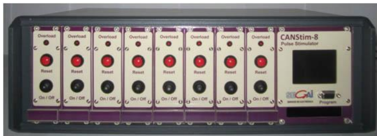
Figura 91 | Vista frontal del electroestimulador CANStim-8.
