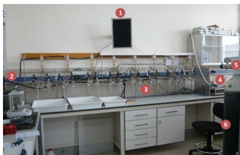
Figura 12 | Fotografía del baño de órganos instalado en el laboratorio de Farmacología del Instituto Universitario de Bio-Órgánica Antonio González de la Universidad de La Laguna. (1) Monitor. (2) Tanque de calefacción de agua. (3) Copas de vidrio. Dispone de un total de 16. (4) Equipos de acondicionamiento de señal y ordenador. (5) Válvula reguladora de gases. (6) Botella de gas.
