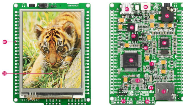
Figura 52 | Mikromedia Board for PIC32. 01) Pines de expansión. 02) Monitor TFT con panel táctil de 320 x 240 píxeles. 03) Conector USB MINI-B. 04) Conector para batería de Litio. 05) Conector de 3.5mm para auricular. 07) Memoria Flash. 08) Codificador/decodificador MP3 estéreo. 09) Botón de Reset. 10) Microcontrolador PIC32MX460F512L. 11) Acelerómetro. 12) Oscilador. 13) LED de alimentación. 14) Slot para tarjeta MicroSD. 15) Conector ICD2/3. 16) Conector Mikroprog. Imagen tomada de www.mikroe.com .
