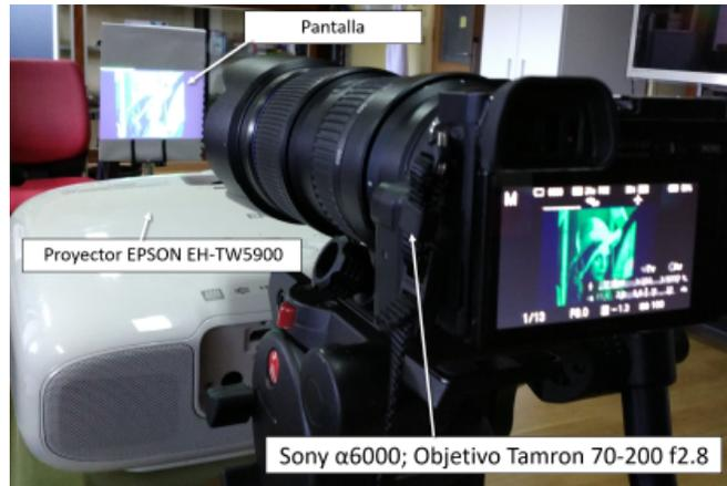
Figura 5.14 Montaje para la evaluación de la técnica sobre proyector EPSON EH-TW5900. Se hace uso de una cámara Sony α6000 con un objetivo Tamron 70-200 f2.8 para la adquisición de imágenes
