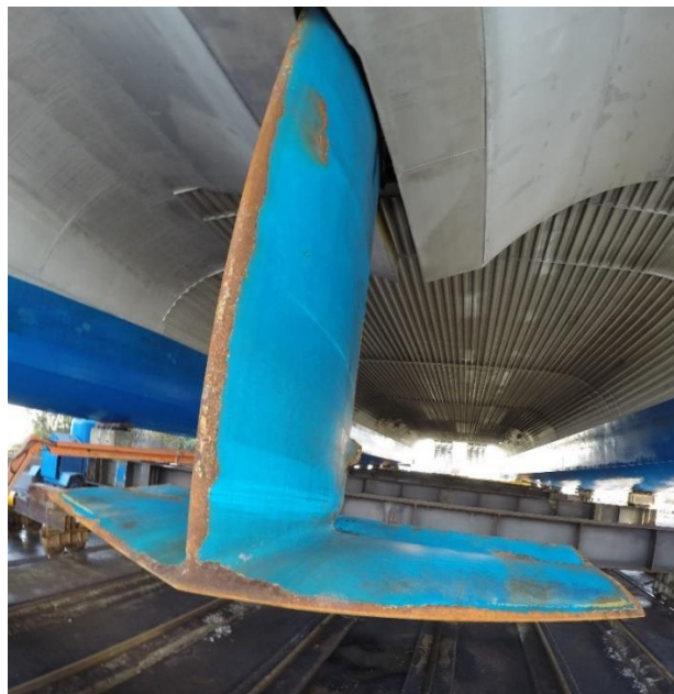
Ilustración nº 53: T-foil previo a las labores de mantenimiento
