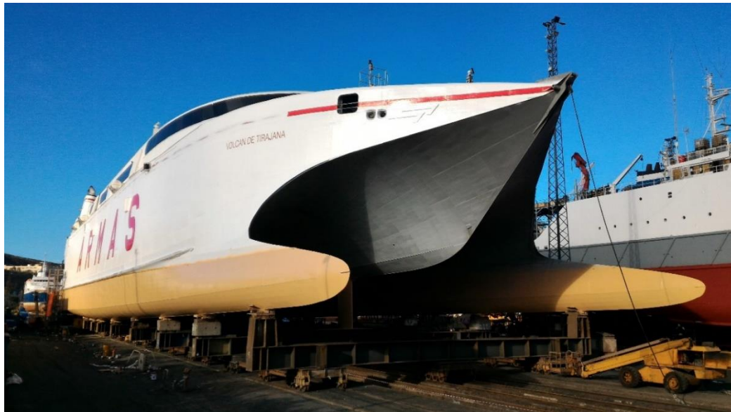
Ilustración nº 58: Aplicación de las dos primeras capas de pintura
