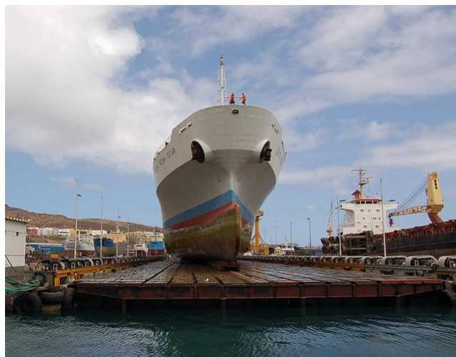
Ilustración nº 26: Plataforma del Syncrolift con los molinetes en sus laterales. Astillero Astican
