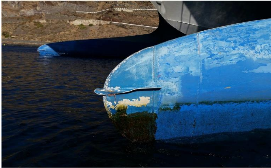
Ilustración nº 43: Flap defectuoso del wave piercing de babor
