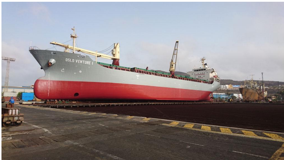
Ilustración nº 28: Buque Oslo Venture en el carro de trasbordo. Astillero Astican
