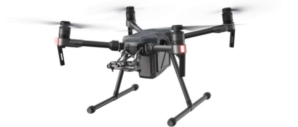
Figura 3: Dron tipo multirrotor. Modelo DJI Matrice 200. Fuente: https://www.dji.com
