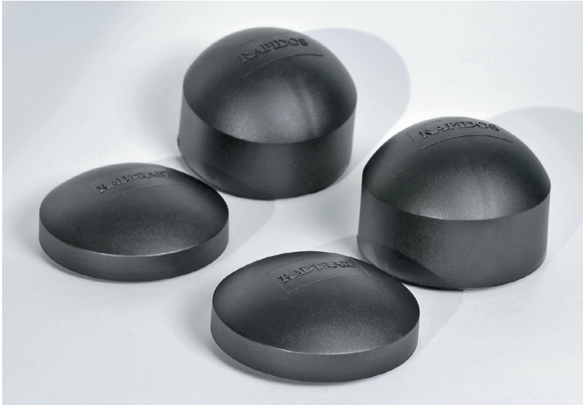
Detectores pasivos de trazas nucleares.
