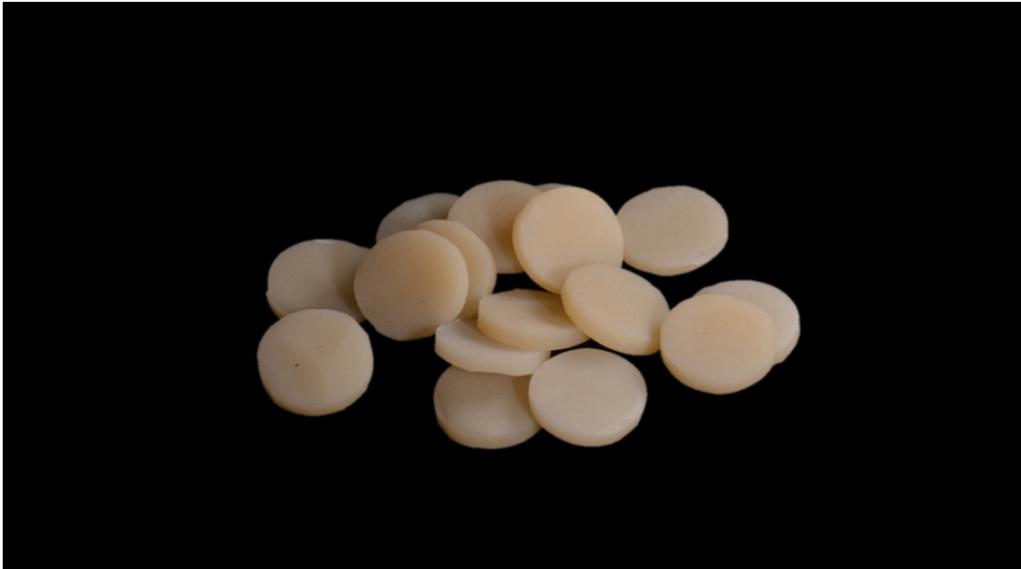
Imagen 9: Conjunto de discos de IPS e.max CAD® tras su preparación.
