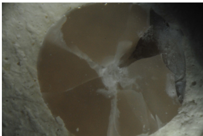
Imagen 17: Muestra ZRLS-SID (17): Fallo tipo mixto, se observa descementado de una porción del material y restos de la capa adhesiva sobre esmalte y dentina.
