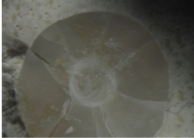
Imagen 16: Especimen RNC-CC (09): Fallo tipo radial con indentación en zona central.
