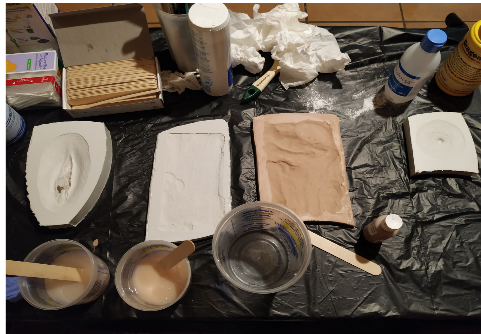
136. Relleno de los moldes de silicona.
