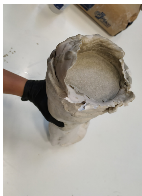
31. Rellenado del molde con escayola.
