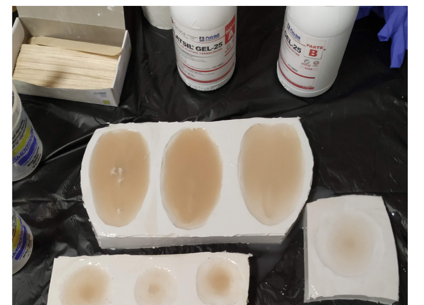
152. Moldes con la silicona ya vertida y listos para desmoldar.
