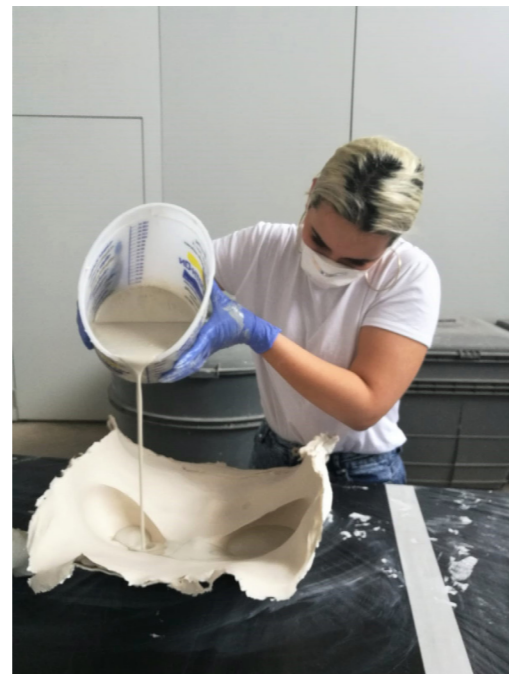
44. Rellenado del molde.
