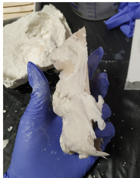
72. Procedimiento de desmoldado.
