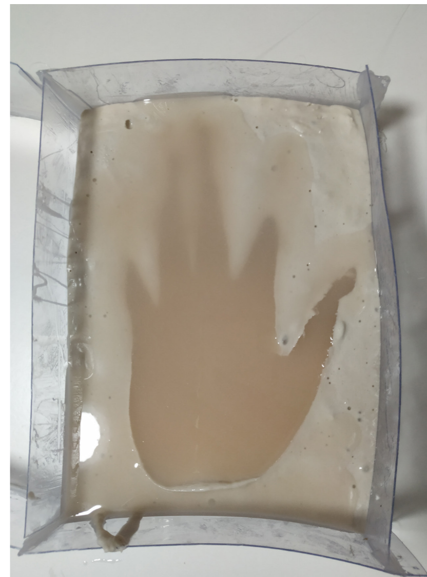
61. Llenado del molde con silicona de platino pigmentada.
