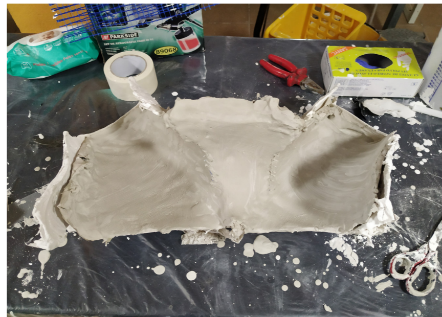
82. Aplicación de última capa de escayola antes de desmoldar la pieza.
