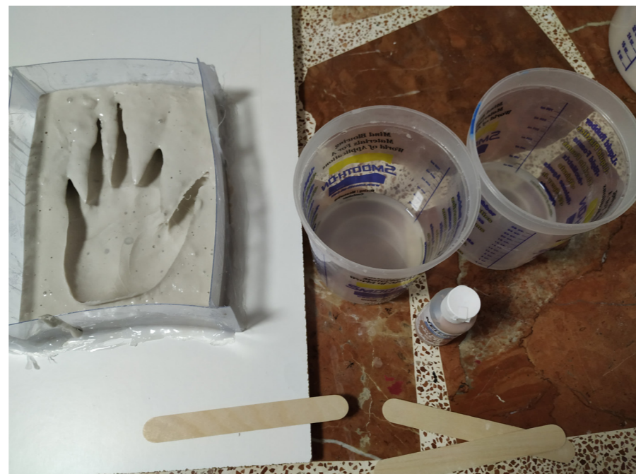
60. Preparación de la silicona de platino.
