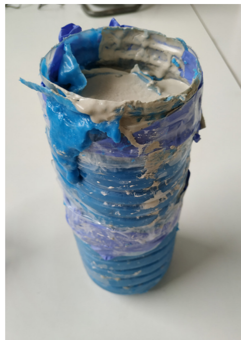
27. Rellenado del molde con escayola.
