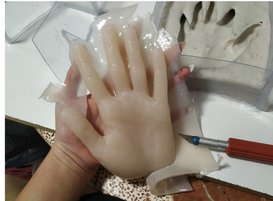
65. Recortado del sobrante de la silicona.
