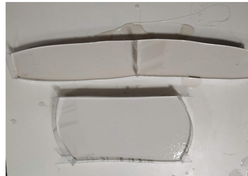
149. Relleno del molde de silicona de estaño
