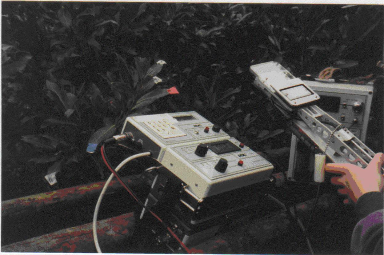
Foto 3.2.2. Analizador de gases por infrarrojo portátil (IRGA).
