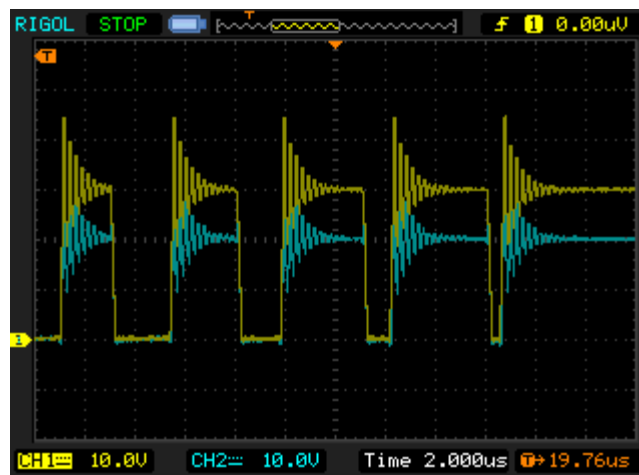
Figura 61. Tensión de puerta (trazo amarillo) y tensión de la fuente (trazo azul) del MOSFET superior.
