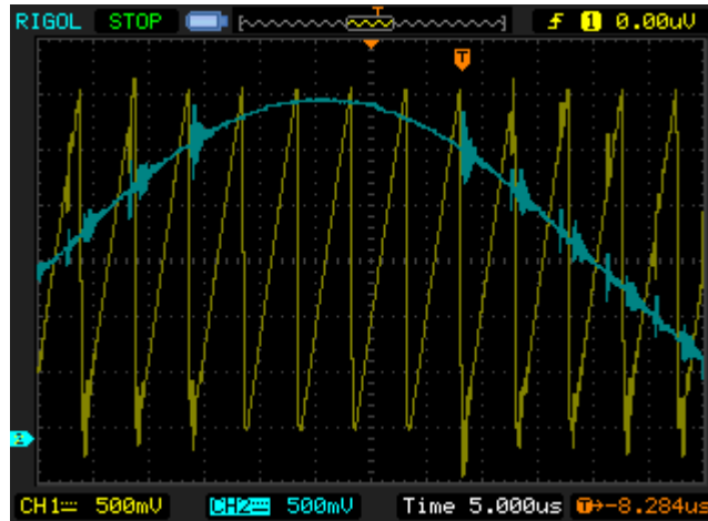
Figura 49. Visualización en el osciloscopio de la señal senoidal de 10 kHz y V_p = 3 V, y la señal en diente de sierra del C. I. TL494.
