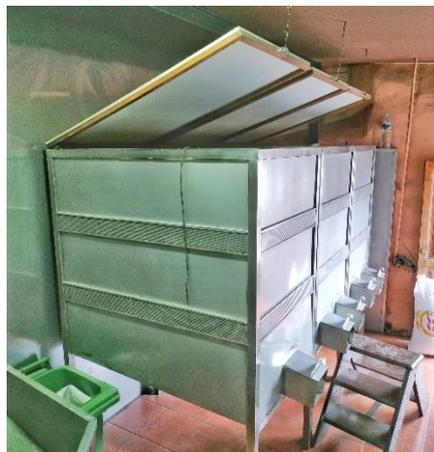
Fig. 11. Depósitos para el grano tostado. Fuente: propia
