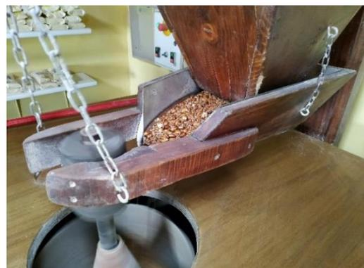
Fig. 7. Detalle de la canaleta. Fuente: Propia
