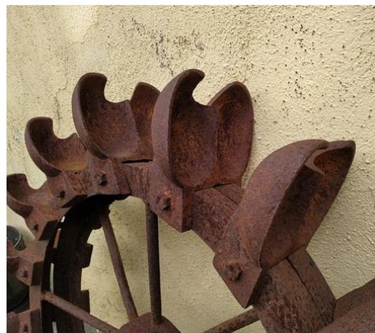
Fig. 15. Detalle de las cucharas del rodezno. Fuente: propia
