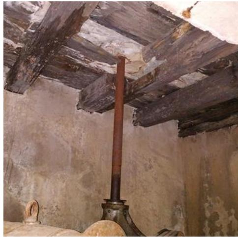
Fig. 16. Eje que transmite la energía del motor. Fuente: propia
