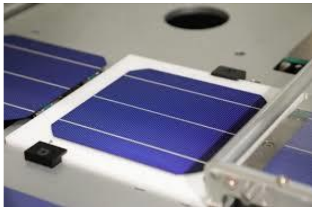
Figura 1. Ejemplo de una célula fotovoltaica de tecnología monocristalina. Fuente: [1].
