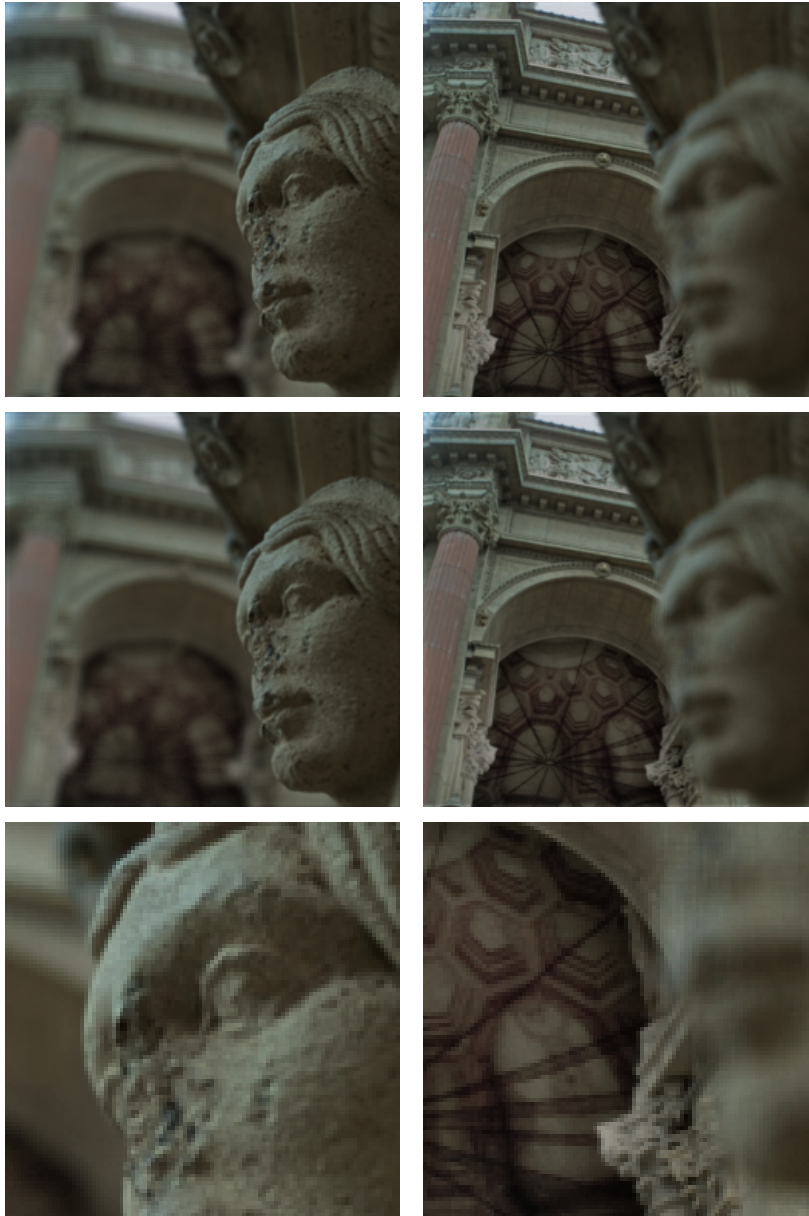
Figura 4.17: Fila intermedia: dos planos de enfoque a distinta distancia pertenecientes a un mismo focal stack , obtenido aplicando la aFST a un lightfield 4D. Fila superior: los mismos planos de enfoque obtenidos con la transformada basada en Fourier de la referencia [Nava 08]. Fila inferior: vista detallada de las imágenes de la fila intermedia, conteniendo regiones dentro y fuera de foco.
