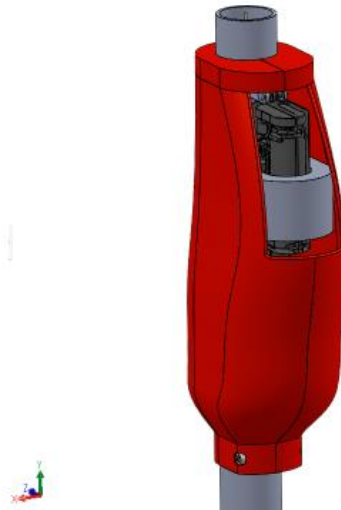
FIGURA 8.31: Conjunto mecanismo de actuación con embellecedor envolvente
