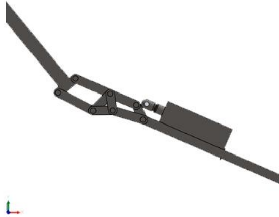
FIGURA 9.10: Actuador empujando pieza inferior
