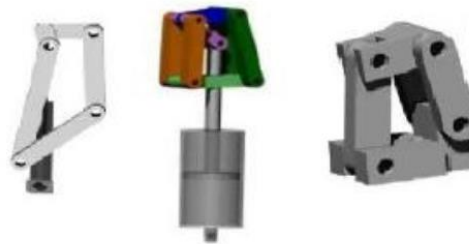
FIGURA 6.3: Mecanismo de cuatro barras
