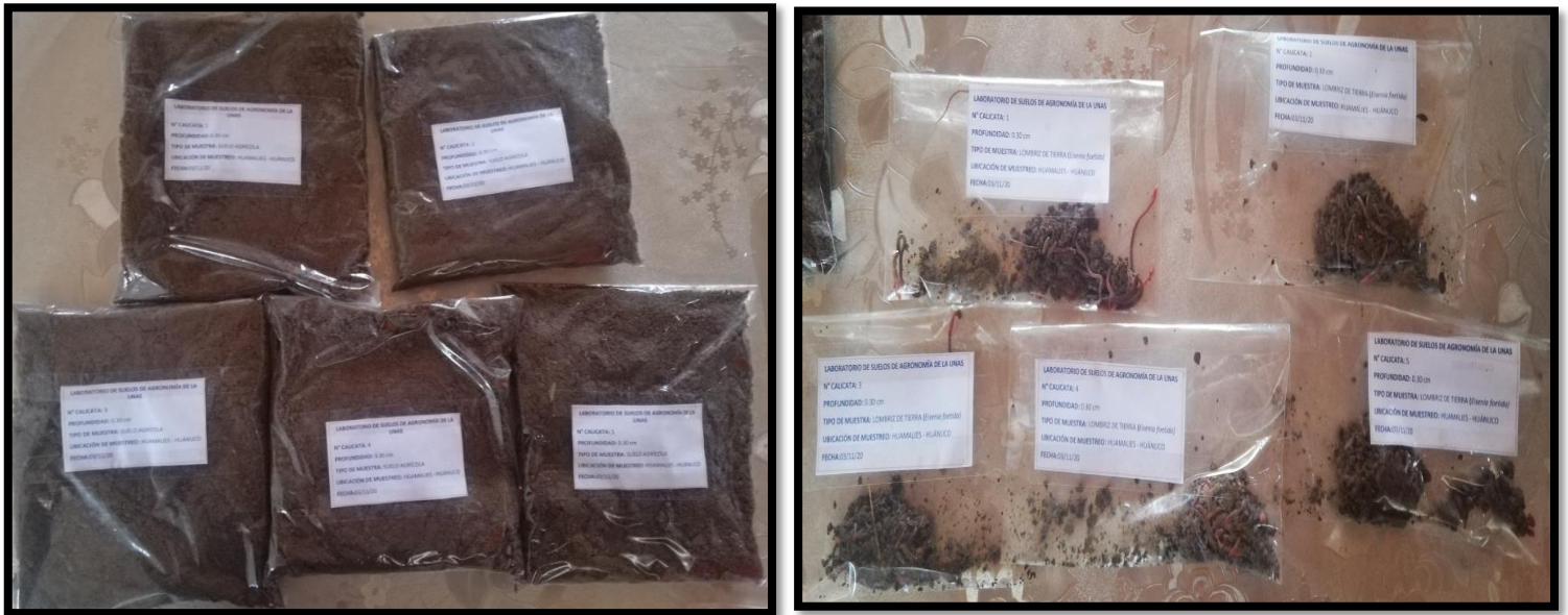
FOTOGRAFÍA 13: IDENTIFICACIÓN DE MUESTRAS EN BOLSAS DE POLIETILENO DENSO.
