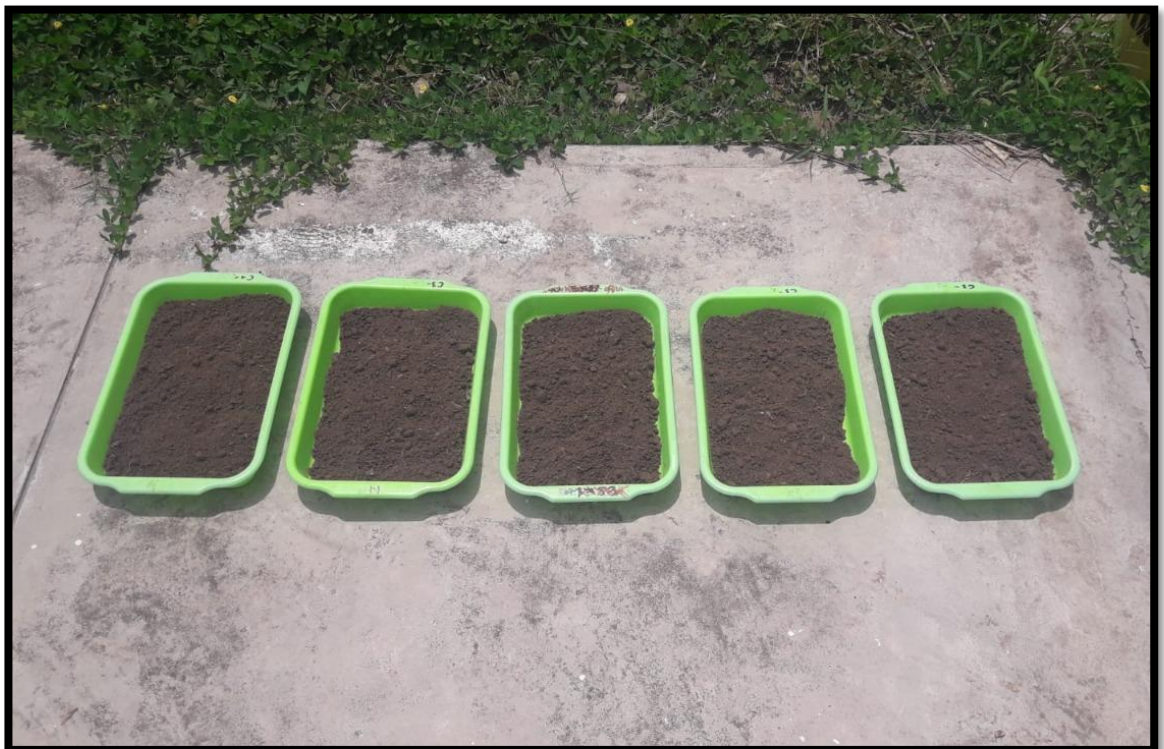
FOTOGRAFÍA 14: SECADO A LA EXPOSICIÓN DEL SOL DE LA MUESTRA DE SUELO
