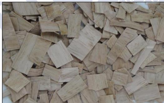
Figura 3.1.2 Chapas de eucalipto
