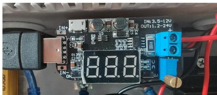
Figura 39. Convertidor CC-CC utilizado en el prototipo. Fuente: propia.
