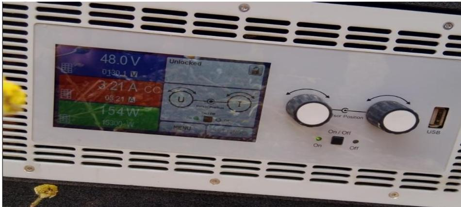
Figura 53. Vista en detalle de la pantalla de control y visualización de la fuente de alimentación. Fuente: propia. Uno de los principales componentes a proteger era la fuente de alimentación debido a su alto coste económico, de forma que, si la corriente en lugar de ser suministrada desde la fuente hacia los paneles recorría el sentido inverso, podría ser dañada.
