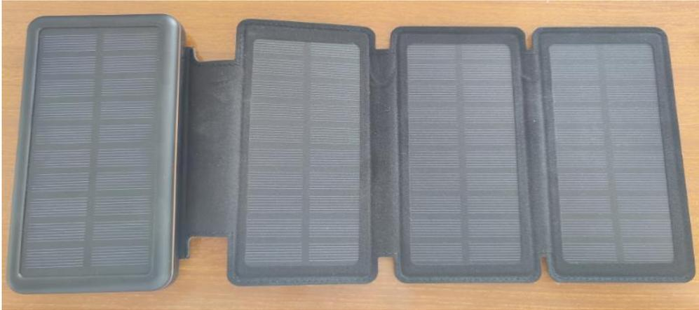
Figura 42. Batería solar para la alimentación del prototipo. Fuente: propia.
