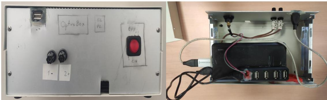
Figura 28. Caja del prototipo (izquierda). Sistema de alimentación batería-hub para el Arduino (derecha). Fuente: propia.
