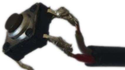
4. Coloque os micro-interruptores nos orifícios da base passando primeiro o cabo e fixe-os com cola forte.
