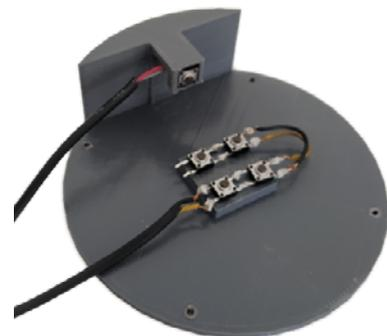
7. Coloque a placa de 3 mm de espessura em cima dos 4 micro-interruptores, certificando-se de que a base com as passagens e o joystick estão na posição correta. Não se esqueça de passar os 2 cabos que saem da tampa pelos 2 orifícios restantes na base.
