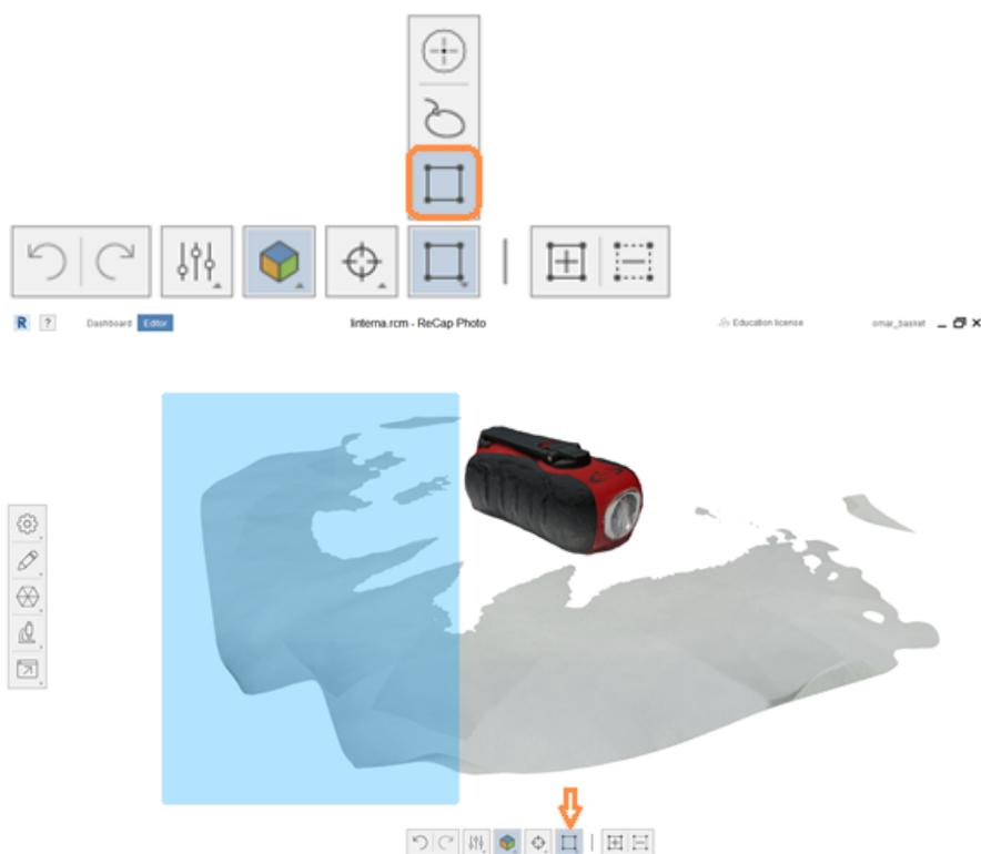
9. As medições do modelo estão definidas em mm, utilizando a ferramenta **Escala e unidade** ao selecionar dois pontos de referência no modelo. A medição é apresentada em **Distância**.
