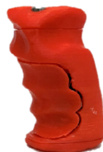
Drukknop geproduceerd door 3D-scanning van een mal (fotogrammetrie).
