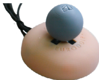
Drukknop ontworpen met software (Catia V5R20), versie 2.
