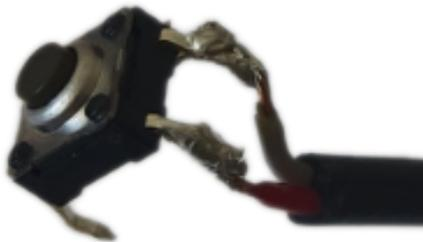
4. Posizionare i microinterruttori nei fori della base facendo passare prima il cavo e fissarli con una colla resistente.
