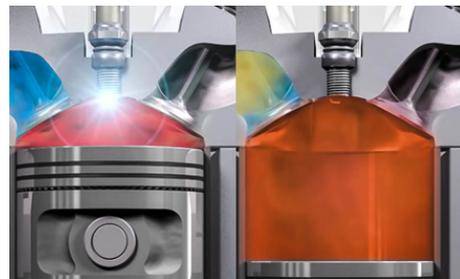
**Figura 6.** Explosión en el cilindro
