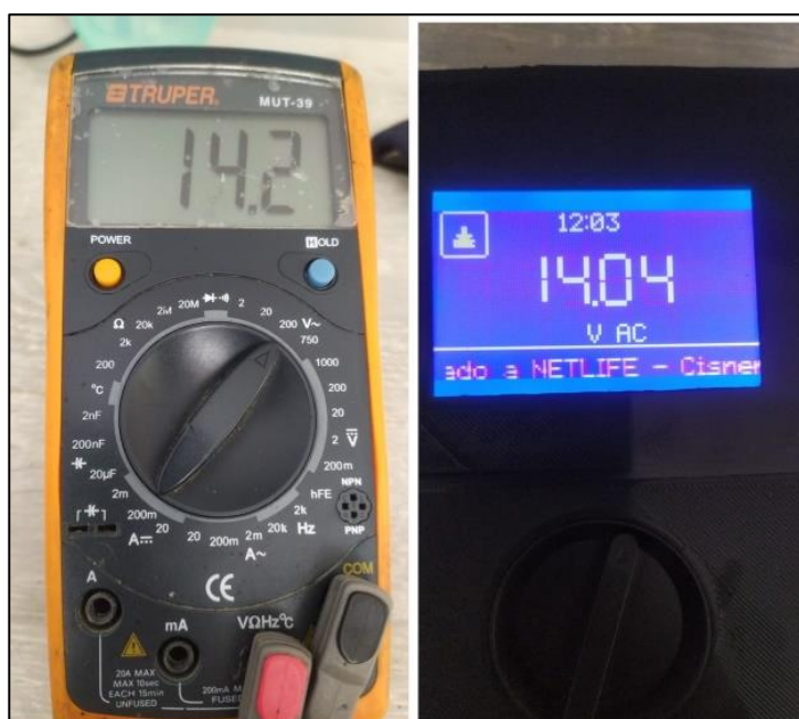
Figura 4.17. Comparación de las mediciones AC con el dispositivo Truper
