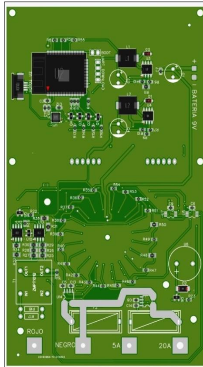
Figura 3.31. PCB del dispositivo de medición
