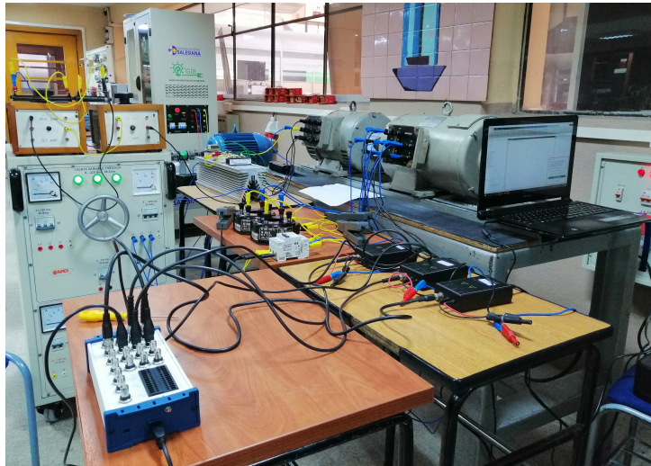
Figura 3.7: Implementación de equipos para adquisición de datos: Cortocircuito Trifásico Súbito en la Máquina Síncrona. Fuente Autores
