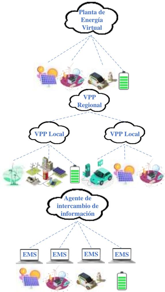
Figura 1. De arriba hacia abajo: VPP control centralizado, VPP control descentralizado y VPP control distribuido.
