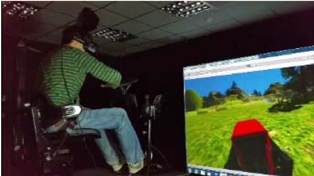
Figura 6. Voluntario conduciendo la plataforma de simulación de movimiento.
