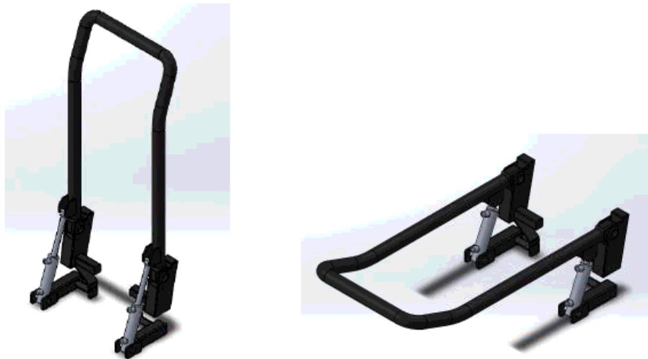
Figura 3. Modelo 3D de los componentes de la ROPS. (izquierda) posición vertical, (derecha) posición horizontal.
