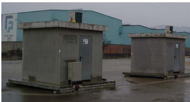
Figura 2: Casetas de hormigón con y sin PCM
