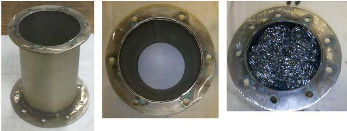
Figura 1: Armazón y mallas de acero inoxidable para recogida de hollín.
