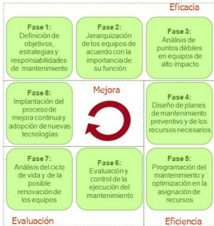
Figura N.º 15: 8 fases relacionada con las técnicas de auditoría de gestión del mantenimiento
