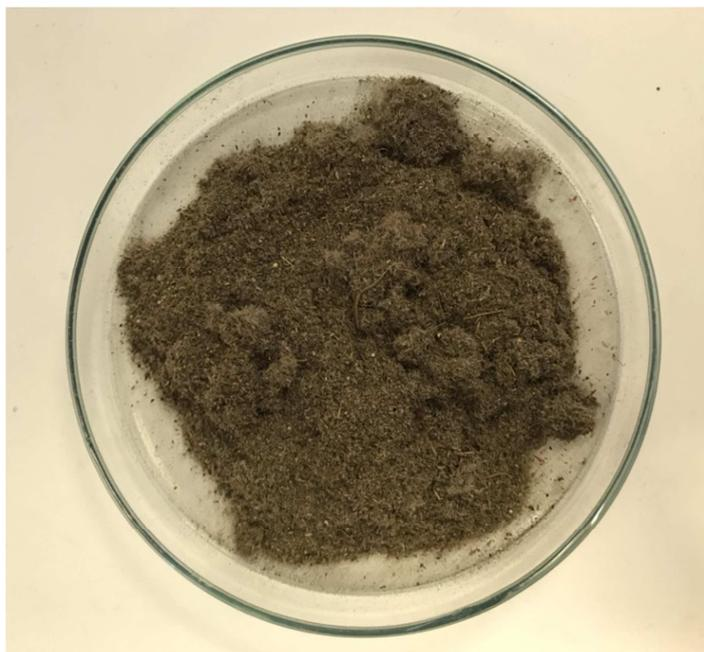
**Figura 2.2:** Amostra do CDR após ter sido triturada e crivada a 500  $\mu\text{m}$ .
