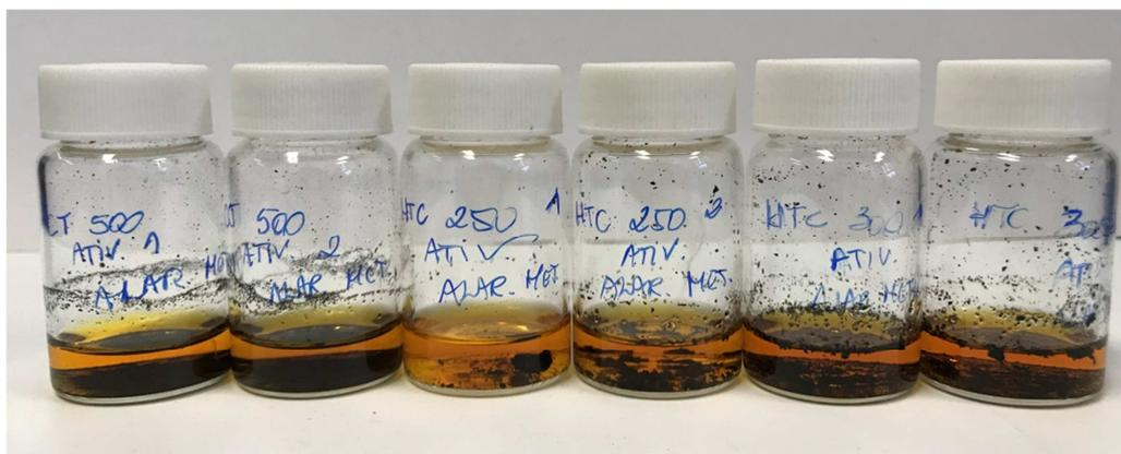
**Figura 3.30:** Adsorções com alaranjado de metilo após 1 semana nos carvões CT3, CH1 e CH2 ativados.
