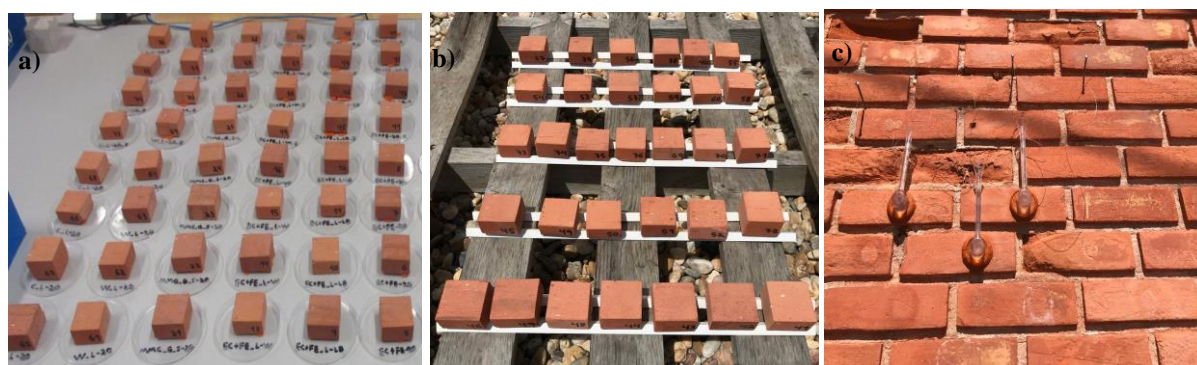
Figura 4.19. Provetes de tijolo biotratados e expostos em laboratório (a), na cobertura do DEC (b) e in situ (c)
