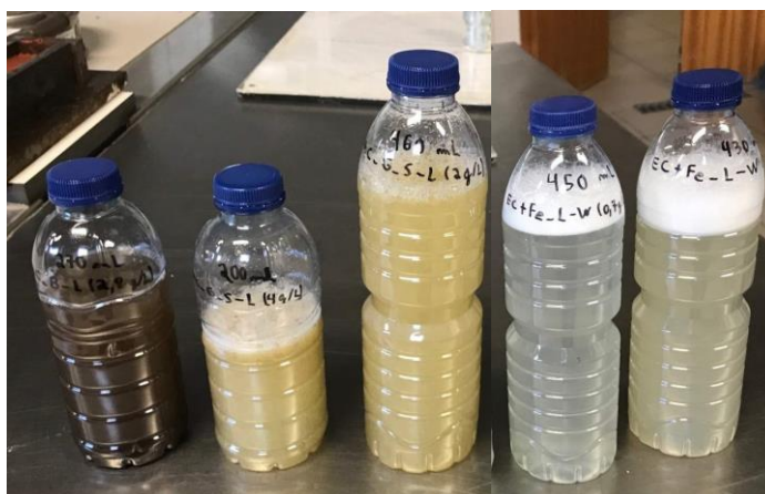
Figura 3.2. Cor da suspensão de seis bioprodutos (da esquerda para a direita, MMC_B_S-L, MMC_G_S-L, MMC_G_S-L+, EC+Fe_L-W e EC+Fe_L-W+) após preparação
