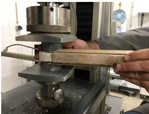
Figura 3.13. Ensaio de resistência à compressão, visualizando-se peça de madeira utilizada para garantir o posicionamento alinhado das peças que garantiam a área de compressão
