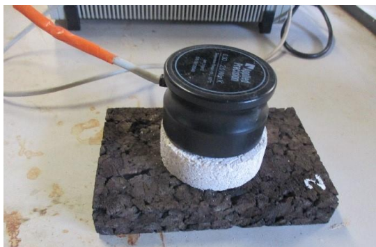
Figura 3.11. Ensaio de condutibilidade térmica de um provete de argamassa
