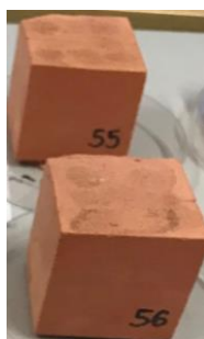
Figura 4.2. Provetes de tijolo biotratados com MMC_B_S-L com leves manchas de cor marrom
